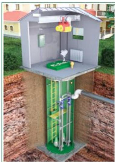
Самый распространенный вариант исполнения КНС. Корпус станции устанавливается в заранее подготовленный котлован и крепится к бетонной плите, выполняющей роль базы-якоря, который препятствует «всплытию» станции. В случае необходимости защиты от несанкционированного доступа к КНС или дополнительной теплозащиты в условиях низких температур, над КНС может монтироваться наземный павильон.
