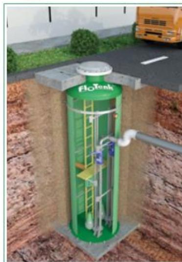
При необходимости размещения КНС под проезжую часть применяются корпуса в классическом исполнении с конструктивным изменением - наличие одной или нескольких горловин диаметром 600 мм, под стандартный чугунный люк. Данное исполнение предусматривает наличие разгрузочной плиты над комплектной насосной станцией. Толщина плиты рассчитывается проектной организацией в зависимости от типа проезжей части и расчетных нагрузок.
